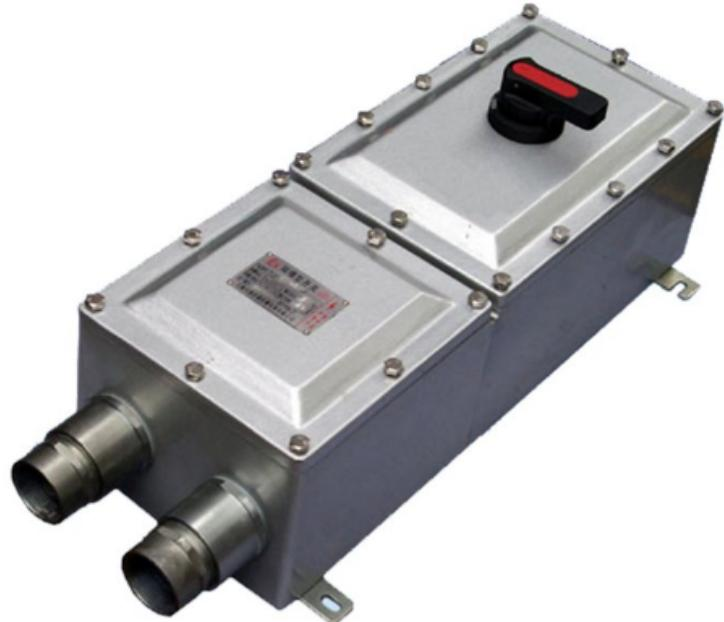
照明防爆配电箱(板)装设的螺旋熔断器其接线不正后果：照明防爆配电箱(板)装设的螺旋熔断器接线不正确将电源线接到螺纹的端子上，影响更换熔芯，而且操作不当，还容易引发触电事故。措施：为保证安全，照明防爆配电箱(板)内装设的螺旋熔断器，其电源线应接在中间触点的端子上，负荷线应接在螺纹的端子上。照明防爆配电箱(板)内不设置N和PE汇流排后果：照明防爆配电箱(板)内不设置N和PE汇流排，无法保证线路安全运行。措施：照明防爆配电箱(板)内，应分别设置零线(N线)和保护地线(PE线)汇流排，零线和保护地线应在汇流排上连接，不得绞接，并应有编号。
